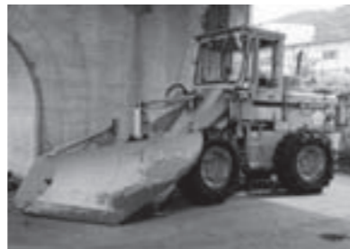
▲ 除雪ドーザー
