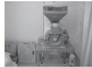
②専用の機械で米粉に加工
