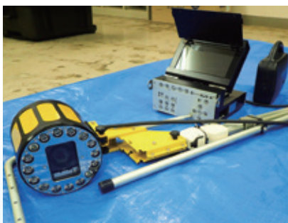
管口カメラとモニター
