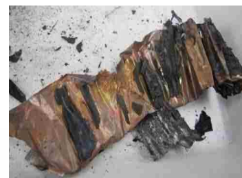
熱暴走後の電極板
