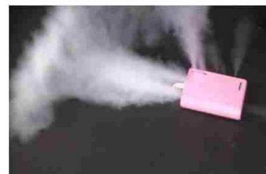
継続的な可燃性ガスを 噴出するような発作動
