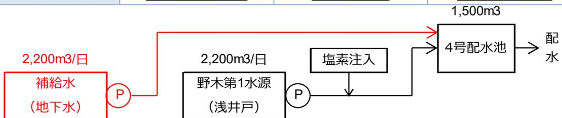
図 4-3 野木水源バックアップ施設整備 概略フロー図
